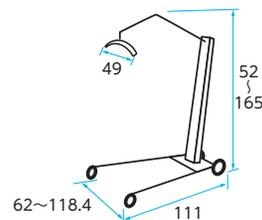
前脚高さが6.1cm。低床ベッドでも使用できるリフトです。手動降下装置、電圧低下時降下機構を装備。
